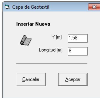
El programa dibuja el geotextil a la altura de la coordenada indicada y prolongándolo hacia la derecha a partir de la superficie de suelo modelada, por la longitud indicada.
